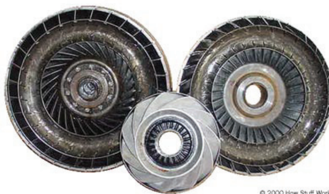
Fig. 4. Componentes de um conversor de torque (HOW TORQUE ..., 2009): à esquerda, a bomba; no centro, o estator; à direita, a turbina
